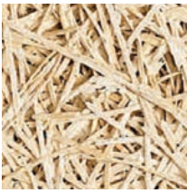
Akustikplatte aus Weisszement gebundener, superfeiner Holzwolle.
