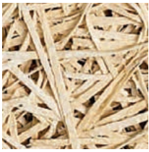
Akustikplatte aus Weisszement gebundener, feiner Holzwole.
