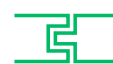
AK-70 Nut + Kamm allseitig, ab Dicke 50 mm Nutzmass 1988 x 588 mm für alle UNITEX Produkte, ausser für UNTEX SW Typ 3
