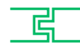
AK-70 Nut + Kamm allseitig, ab Dicke 50 mm Nutzmass 1988 x 588 mm für alle UNITEX Produkte, ausser für UNTEX SW Typ 3
